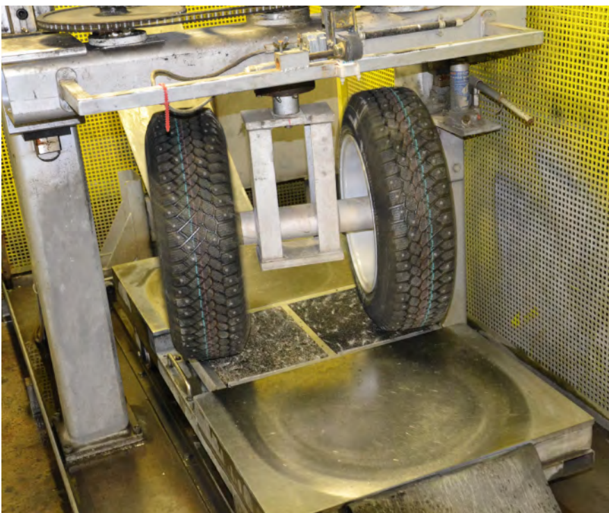
Provningsutrustning enligt modifierad laboratoriemetod prEN 12697-50 "Resistance to Scuffing". Utrustningen finns vid Institut für Strassenwesen i Aachen.
